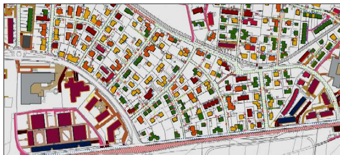
Abb. 14: Die Umbaustadien der Wohngebäude (oberes Bild: grün: weitgehend original, dunkelrot: neu verdichtet errichtet mit dem Bedarf einer kollektiven Stellplatzanlage) und Erschließung der Wohngebäude (rote Pfeile Stellplatzausfahrt, blaue Pfeile Hausausgänge) als Unsicherheitsfaktor für Fahrzeugbewegungen in engen Straßenraum und als Datenschutzproblem für die Privatsphäre der Anwohner. (Quelle: Transforming Cities, 2/2016, 13)
