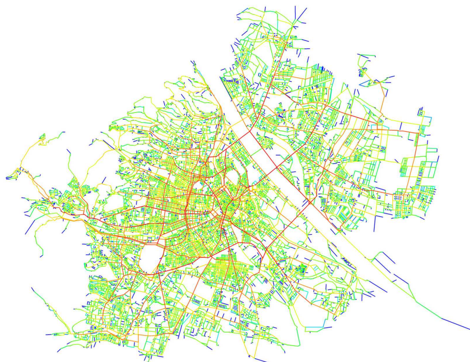
Abb.5: Flow Pattern: Angular Analysis Choice N: Wien 2006. Die rot dargestellten Routen zeigen die vorrangige Wahl.
