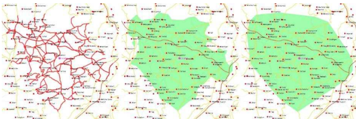
Abbildung 13: Beispiele für 3 Ergebniskarten mit unterschiedlichen Verfahren zur Darstellung des Erreichbarkeitspolygons a.) gepufferte Strassengeometrie, b.) Isolinenberechnung c.) konvexe Hülle
