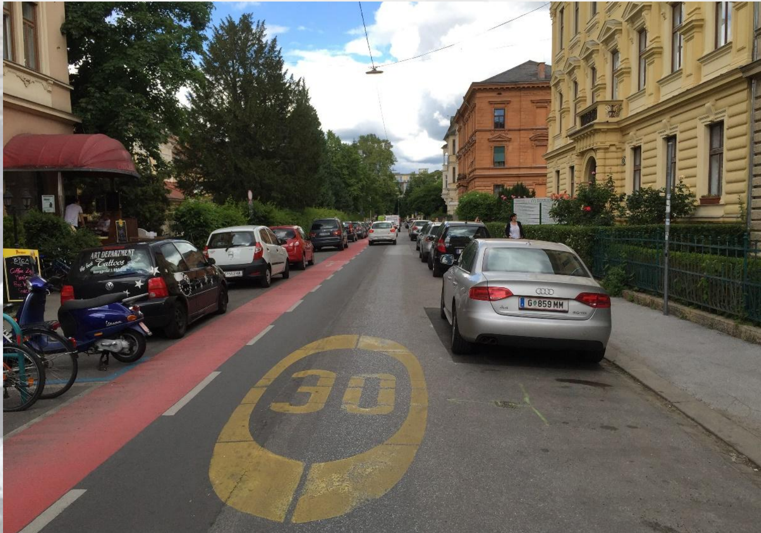
Trennung von Verkehrs-, Rad- und Fußgängerfläche
